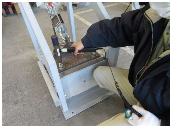
写真-3 測定状況(大ハンマ軸方向打撃)
