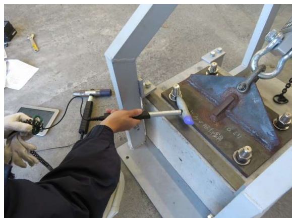
写真-4 測定状況(中ハンマナット側面打撃)
